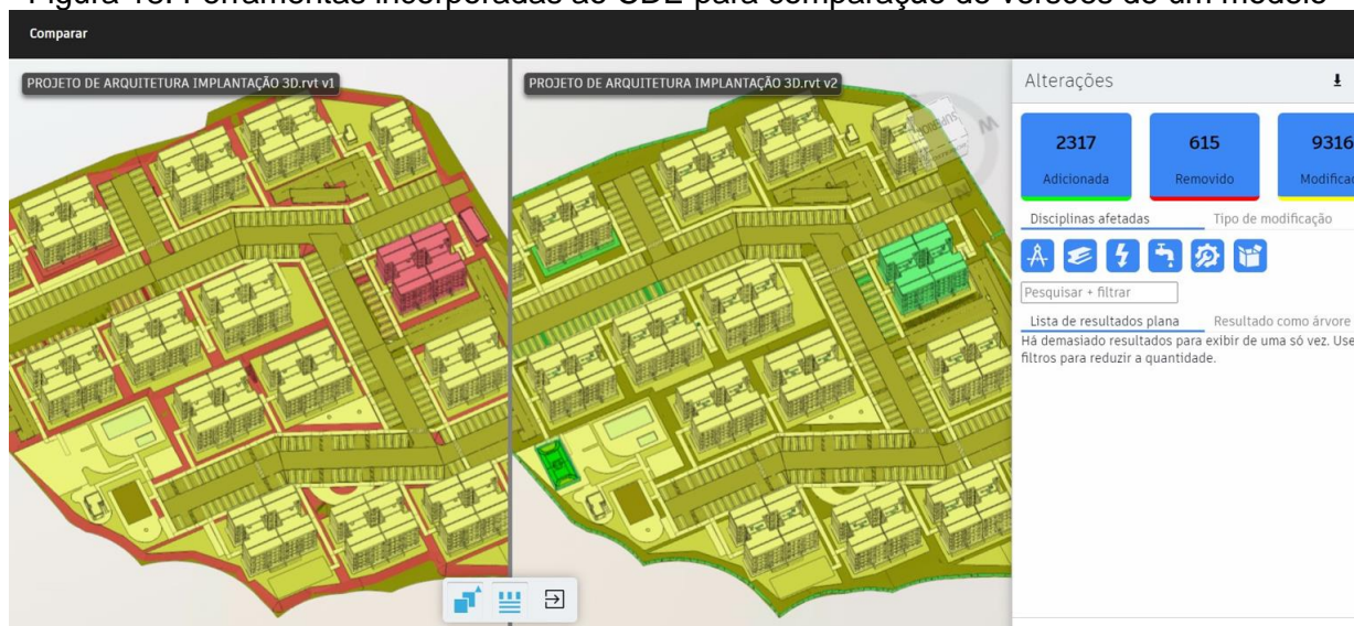
Figura 18. Ferramentas incorporadas ao CDE para comparação de versões de um modelo
